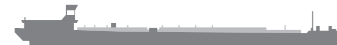
Modernes Güterschiff mit 110 Metern Länge und Teilbeladung (ca. 2400 Tonnen Nutzlast) auf Kanälen oder Nebenflüssen des Rheins (2,8 Meter Tiefgang).
