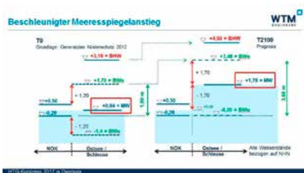
Bemessungs- und Betriebswasserstände (BWo, BWu) mit und ohne beschleunigtem Meeresspiegelanstieg von plus 1,74 m)
