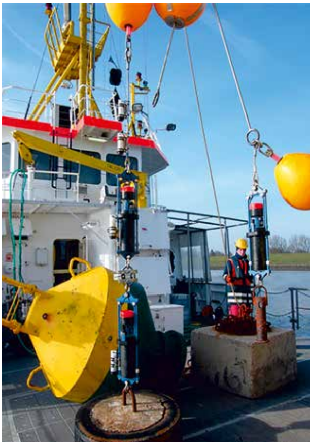
Messstrang mit Dauerströmungsmessgeräten, CTD Sonden und Warntonne an Bord des Messschiffes FRIESLAND
