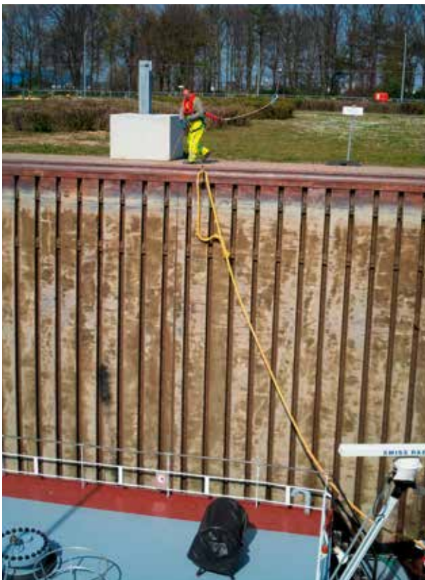
Hinaufziehen der Schiffstrosse durch den Festmachergehilfen an der Absturzsicherung
